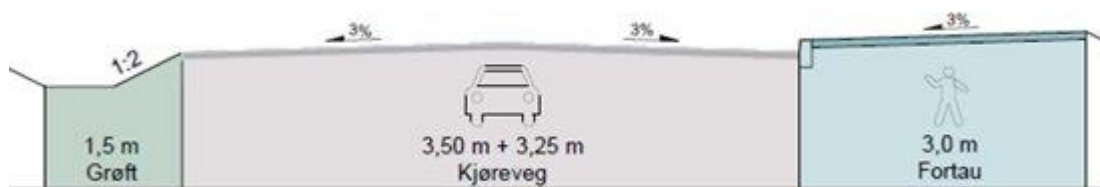
Figur 4: Snitt av vegen med grøft og fortau, med utgangspunkt i Melhus kommunes vegnorm. (Norconsult).
